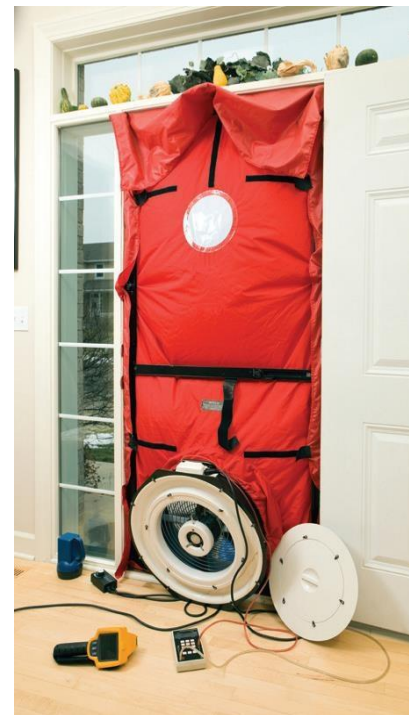
Blower Test Door
