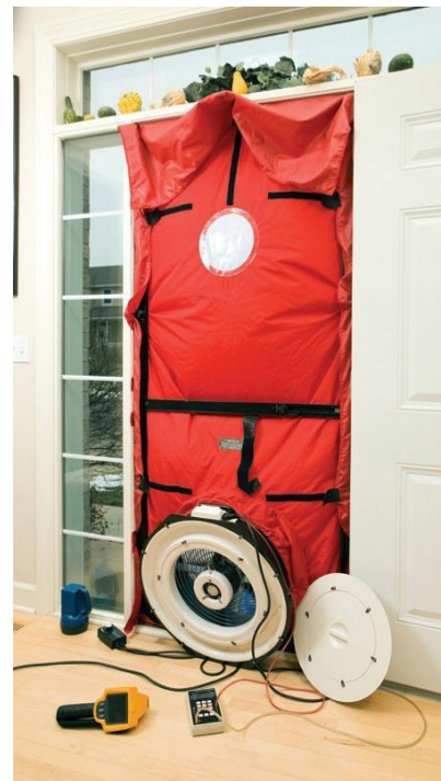
Blower Door Test
