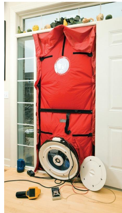
Blower Test Door
