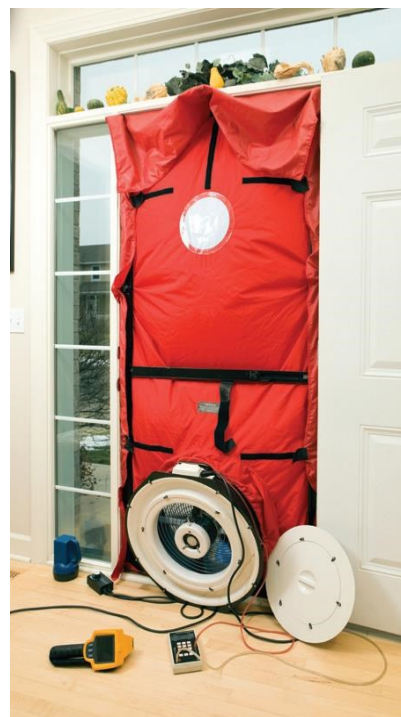
Blower Door Test
