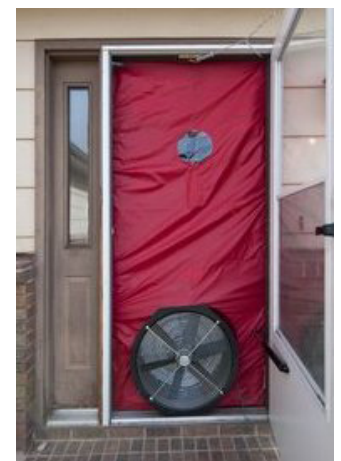
Blower door test
